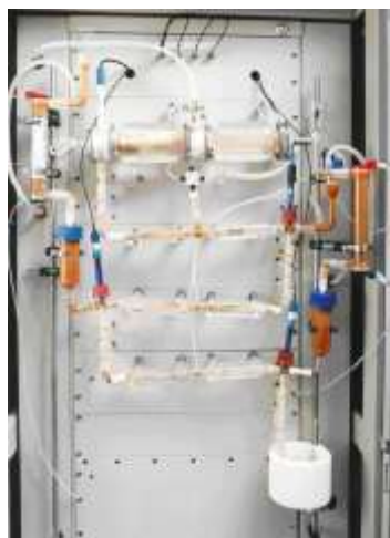
Фото 6. Прибор TIM, имитирующий желудочно-кишечный тракт.
