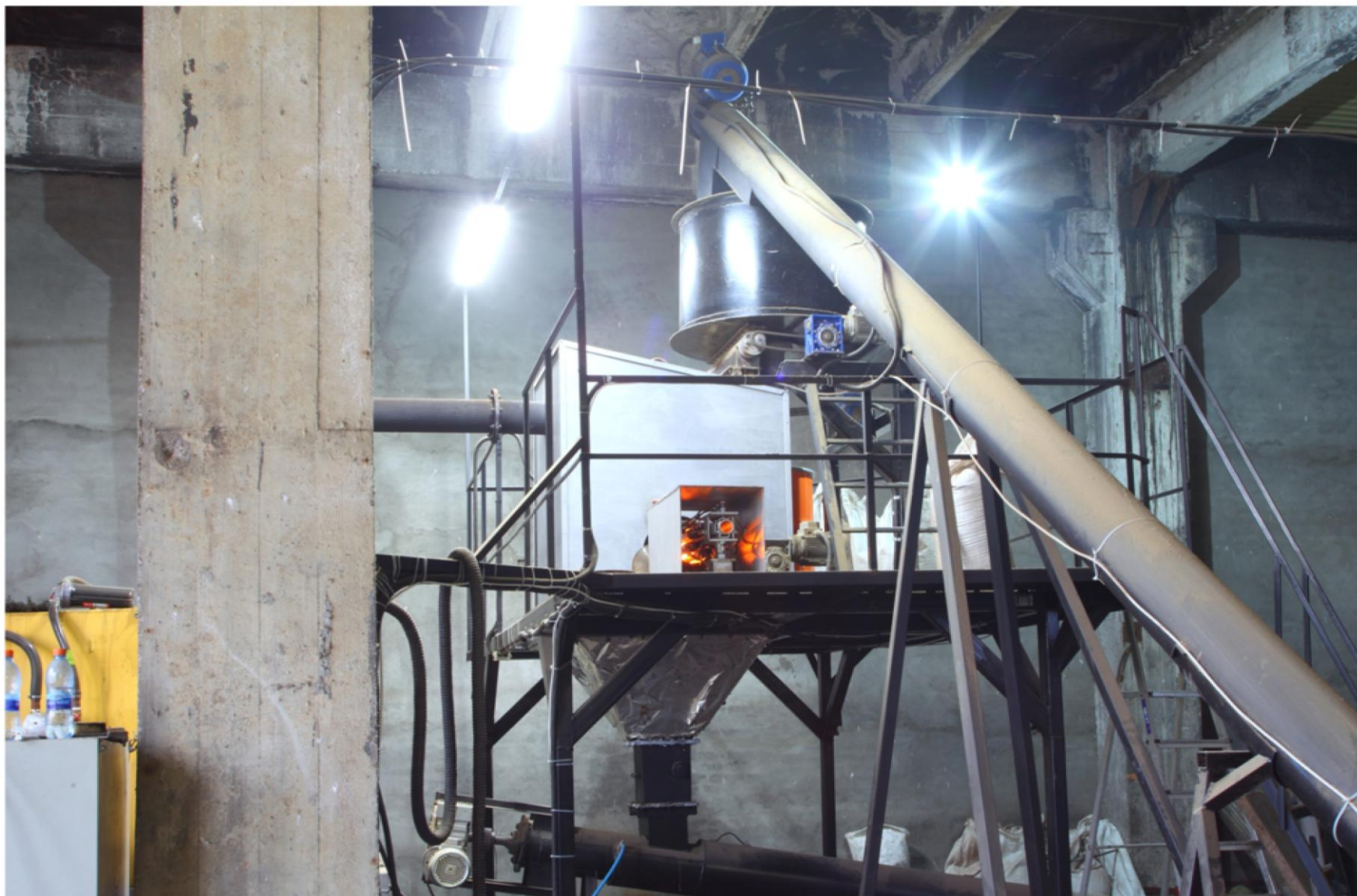
Пиролизный реактор с системой загрузки и дозатор
