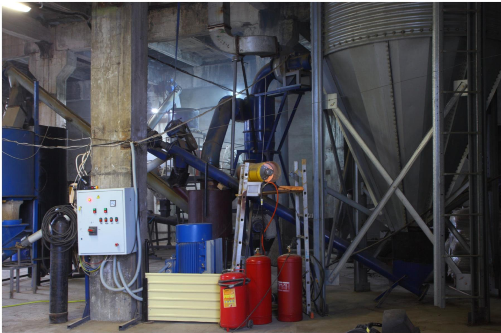
Бункер сепарированного сырья и аэродинамическая сушилка
